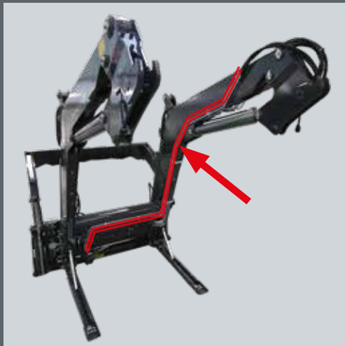
Укладка труб для REAL3 rd
