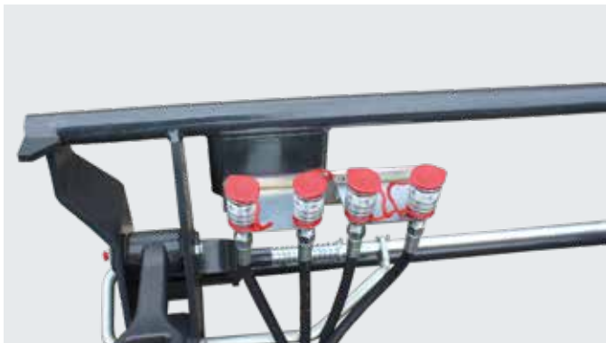
3-я и 4-я линия гидравлики (здесь с быстроразъемным соединением) Для простого управления такими рабочими органами с гидроприводом, как ковш для силоса, захват для тюков и вилы-штабелер.
