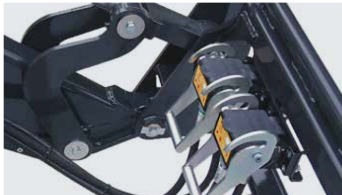
Фиксация рабочих органов (Tool-Fix) Двойное соединение для 3-й и 4-й линии гидравлики.
